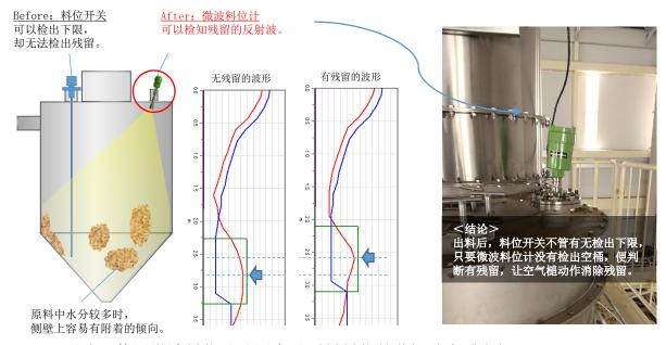
※照片: 使用微波料位计计测食品原料料位并监视残留或鼠洞
